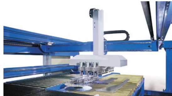
Im Bild holt der LUR eine neue Blechtafel aus dem Stapel, der unter dem seitlich verfahrenen Ab- lagetisch liegt. Die Maschine ist dabei mit der Bearbeitung einer anderen Tafel beschäftigt
