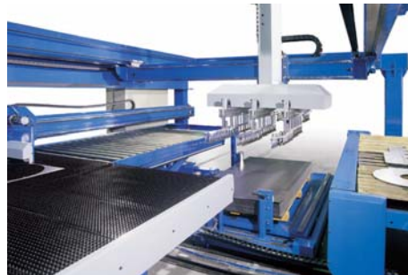
Im Bild holt der LUR eine neue Blechtafel aus dem Stapel, der unter dem seitlich verfahrenen Ab- lagetisch liegt. Die Maschine ist dabei mit der Bearbeitung einer anderen Tafel beschäftigt
