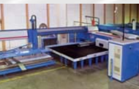
Die Stanz/Laser-Kombi beschleunigt seit einigen Monaten bereits die Herstellung der Edelstahl-Oberplatten.
