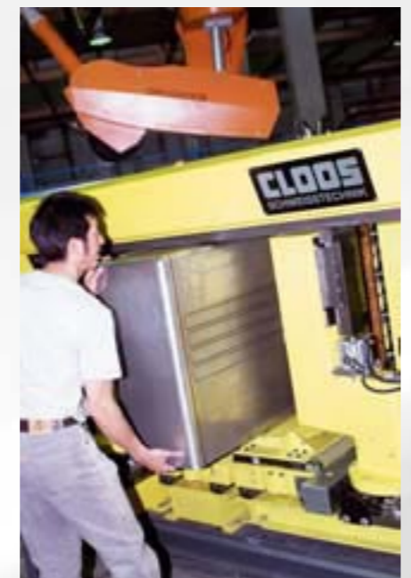
Die Handarbeit beschränkt sich auf das Einlegen der Rohteile und die Entnahme des fertigen Unterbaumoduls.
