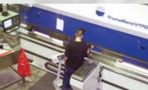
Auf der Trumabend werden die Mantel- sowie die Wandbleche der Unterbaugruppen präzise gebogen.
