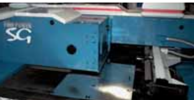
Die Stanz/Scher-Kombi ShearGenius sorgt für hohe Produktivität und Genauigkeit beim Stanzen der Bleche.
