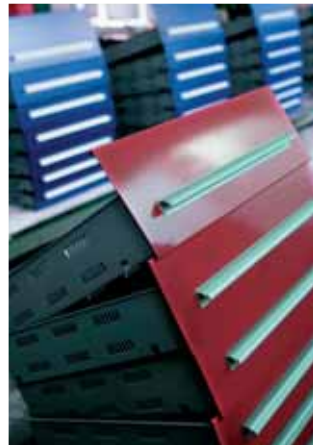
Die Ausbrüche und Prägungen nahe Biegelinie stellen hohe Ansprüche an Biegezentrum von FinnPower.
